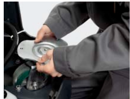
Einfacher Stützradwechsel für geringen Wartungsaufwand
